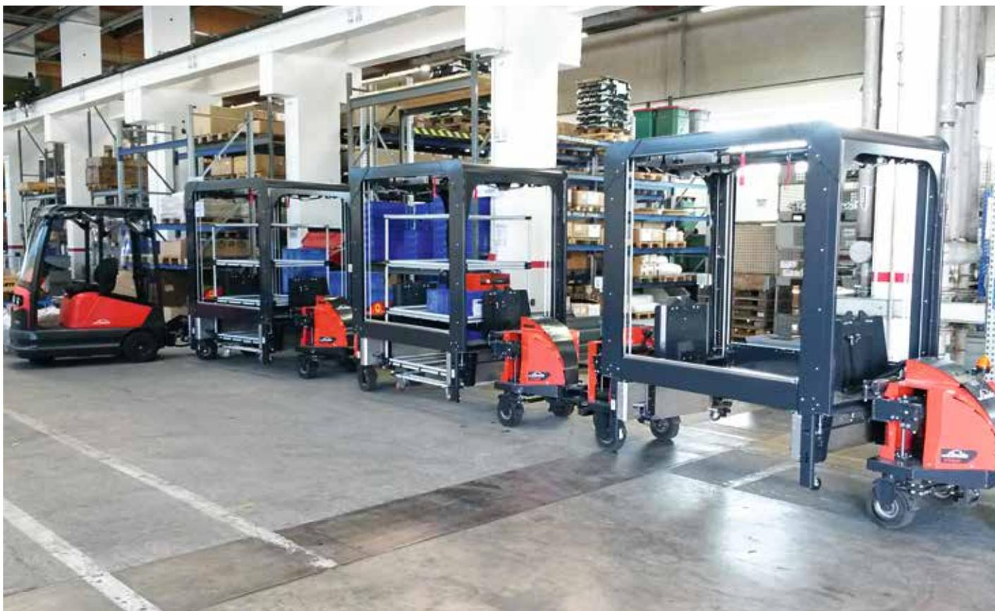
Der modulare Aufbau des Factory Trains, mit seinen flexibel auswechselbaren Warenträgern, erlaubt die Anpassung der Transporte an wechselnden Bedarf und gleichzeitig den Transport unterschiedlichster Güter. Die besonders wendige und spurtreue elektromechanische Lenkung bildet in Verbindung mit der Warenträgerfederung eine leistungsstarke Lösung für innerbetriebliche Transporte.
