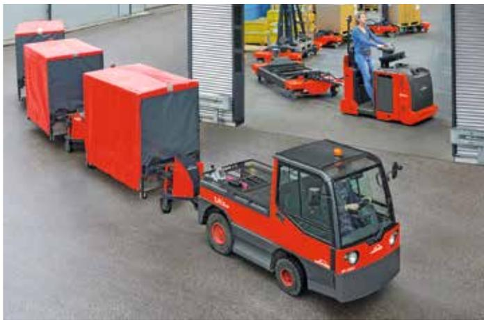
Hohe Spurtreue und kleiner Wendekreis durch elektrisch-mechanische Lenkung mit zusätzlicher Lenkwinkelerweiterung auf 120° Lenkeinschlag zwischen zwei Warenträgern.
