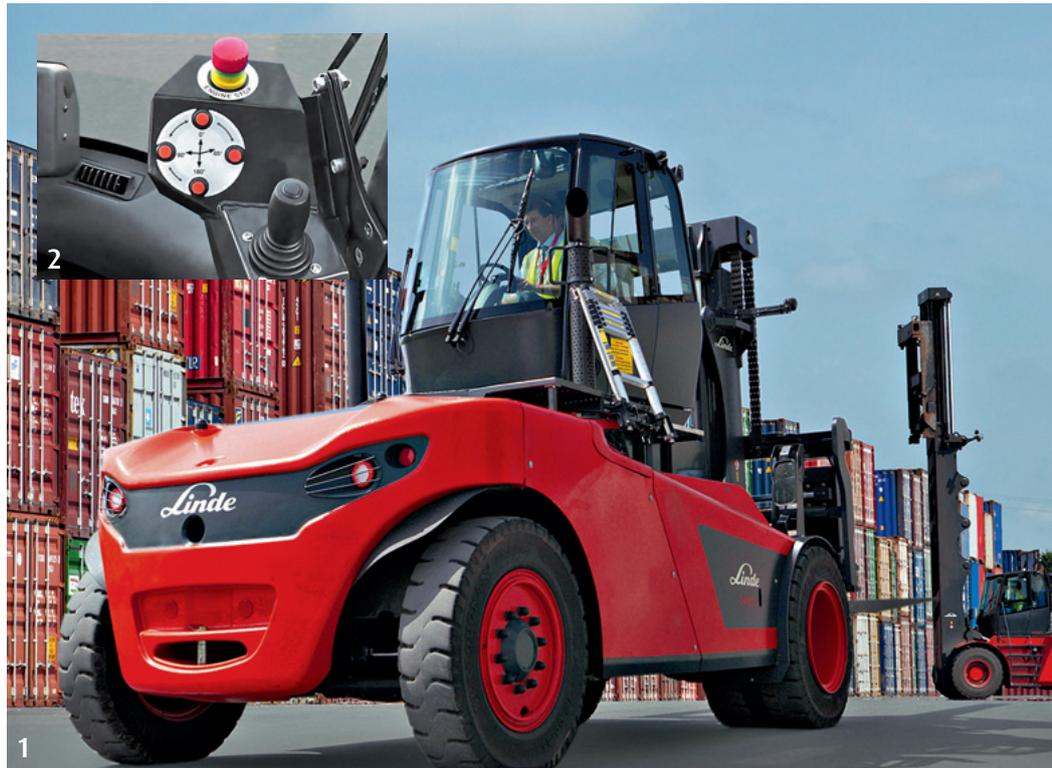
Durch die Drehkabine hat der Fahrer zu jeder Zeit eine optimale Rundumsicht (Bild 1). Die gegenüber dem Standardmodell um 600 Millimeter erhöhte Kabine kann stufenlos über Positionsschalter beziehungsweise per Joystick um bis zu 180 Grad nach links oder 65 Grad nach rechts gedreht werden (Bild 2).
