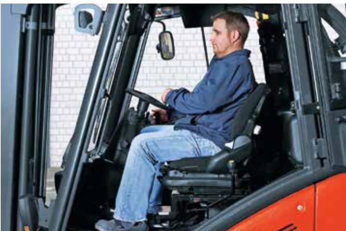
Mit einem einfachen Handgriff wird der gesamte Arbeitsplatz in die gewünschte Position gebracht. Durch leichtes Kopfbewegen hat der Fahrer so immer einen optimalen Blick in Fahrtrichtung – auch bei Rückwärtsfahrten.
