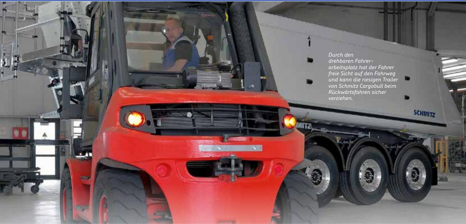
Durch den drehbaren Fahrer-arbeitsplatz hat der Fahrer freie Sicht auf den Fahrweg und kann die riesigen Trailer von Schmitz Cargobull beim Rückwärtsfahren sicher verziehen.
